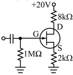
37. 下圖所示之 FET 放大器電路中， $A_v = v_o(t) / v_i(t)$  為小信號之電壓增益，試問移除旁路電容  $C_B$  後，其  $|A_v|$  與移除前比較有何不同？ (A)變小 (B)變大 (C)不受影響 (D)極性改變
